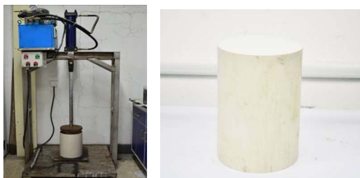
图 4.3 新型成型装置（左）和圆柱体浮力材料（右）
