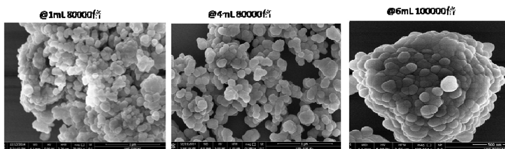
图 4.4 以不同量 \text{Fe}_3\text{O}_4@\text{SiO}_2 为核制备的 \text{Fe}_3\text{O}_4@\text{SiO}_2@\text{PPy}
